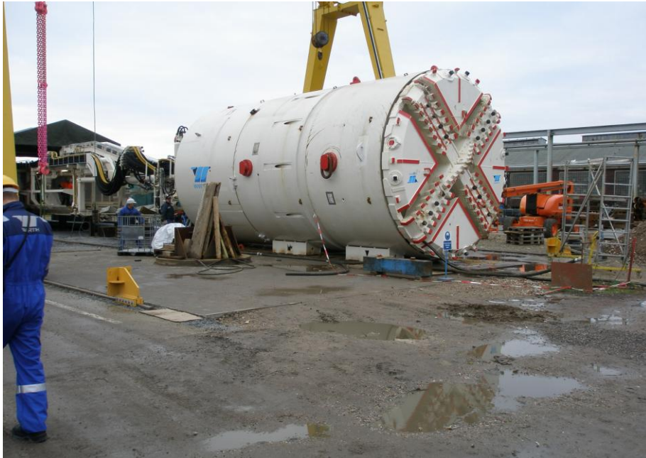
Cilindrični mehanizovani štit sa rotacionom reznom glavom
